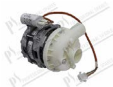
Pompa di lavaggio monofase 400W 230V 50Hz aspirazione Ø 45 mm; uscita Ø 40 mm; 2800 rpm; cavo L=460 mm; C=12,5µF 400V
