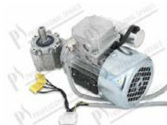
Motoriduttore monofase 110W 230V 1.0/0.9A 50/60Hz asse Ø 14 mm; rpm 1320/1580; cavo L=110 mm; condensatore 8µF 400V
