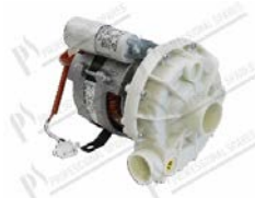
Pompa di lavaggio monofase 370W 230V 50Hz 2,3A aspirazione Ø 45 mm; uscita Ø 40 mm; cavo L=490 mm; C=10µF/450V
