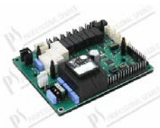
Scheda madre (senza eeprom) dim: 145x125 mm - AMX / AUX / FX/GX & FP/GP / ECOMAX 402-602 / GC / GCP
