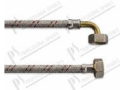
Tubo flessibile treccia INOX 3/4"FF con filtro - L=3000 mm DN10, Tmax 70C°
