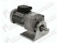
Motoriduttore trifase 90/110W 230-415/440-460V 50/60Hz rapporto di riduzione 98,3; 14rpm
