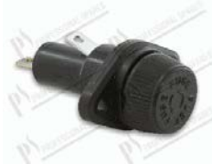
Portafusibile 15A 600V L=42 mm per fusibili Ø 10,3x33,6 mm
