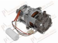
Pompa di aumento pressione monofase 320W 230V 50Hz 1.5A entrata/uscita Ø 11,65 mm; C=8µF 425V
