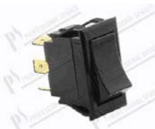
Interruttore 2P 125-250V 15/10A dima di foratura 37x21 mm
