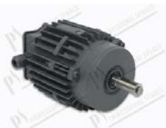
Motore trifase 180W 220-240/380-415V 50Hz 254/440V 60Hz albero Ø 14x43,5 mm; 2850/3450 mm
