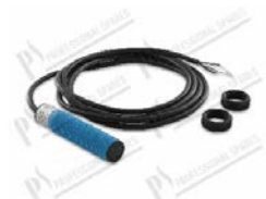
Fotocellula VT18-2T1132 M18x1; cavo L=2000 mm; 20-253Vac; temperatura di lavoro -25°C.....+70°C
