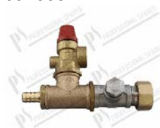
Valvola limitatrice di pressione con portagomma per tubo Ø 14,5 mm; con ghiera 1"
