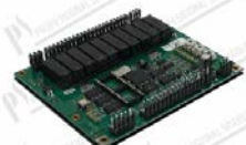
Scheda madre (senza eprom) dim. 120x145 mm - GX / FX / UX60
