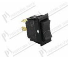
Interruttore 20,5x33 mm 10A 250V; faston 6,3x0,8 mm
