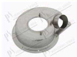
Chiocciola per pompa aspirazione Ø 83 mm; mandata Ø 65,5 mm
