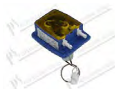
Pompa peristaltica brillantante portata fissa mod. PP; portata fissa 1,25 L/h; 0,5 bar; 24V 3,5W; tubo in sekobril con portagomma Øest. 6,5 mm ; L cavi = 205mm
