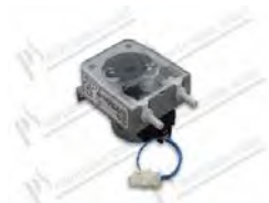
Pompa peristaltica brillantante portata fissa (uso interno) mod. PG0,4; portata fissa 0,4 L/h; 0,5 bar; 230V 8W; tubo in sekobril con portagomma Øest. 6,3 mm
