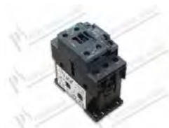
Contattore 3RT2023-1AC20 4kW 400V 3P; 24V 50/60 Hz; 1 NO+1NC; dim. 97x45x85 mm
