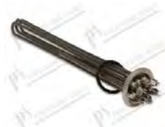
Resistenza boiler 6000W 230V L=410 mm; flangia Ø 64 mm; Øint. 50 mm; 2 x guaina portabulbo L=195 mm
