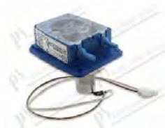
Pompa peristaltica brillantante portata fissa (uso interno) mod. PP; portata fissa 0,5 L/h; 1,25 bar; 24V 50/60Hz; cavo L=390 mm; tubo in SBR
