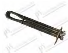
Resistenza boiler 4500W 230V L=255 mm; flangia triangolare 83,5x78,7 mm; Øint. 50 mm; guaina portabulbo L=150 mm
