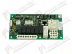
Scheda elettronica MIKE2-E/A1 dim. 75x150 mm
