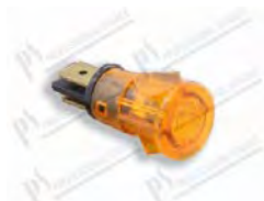
Lampada spia arancione Ø 13 mm 230V - autobloccante testa Ø 15 mm; L=33 mm; faston 6,3x0,8 mm; Tmax 120°C
