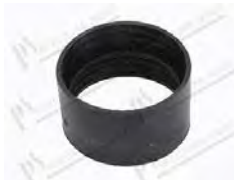
Manicotto 70x46 mm EPDM Ø ext 85mm; Ø80 mm ; H = 46mm ; Spessore gomma 4 mm
