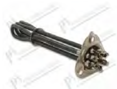
Resistenza boiler 4500W 230V L=260 mm; flangia triangolare 83,5x78,7 mm; Øint. 50 mm; guaina portabulbo L=120 mm
