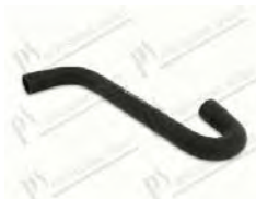
Tubo sagomato Ø 23x30 mm EPDM dim. 315x190 mm
