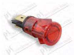
Lampada spia 230V Ø 13 mm - rosso - autobloccante testa Ø 15 mm; L=33 mm; faston 6,3x0,8 mm; Tmax 120°C
