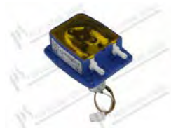
Pompa peristaltica detergente portata fissa mod. PP; portata fissa 7 L/h; 0,1 bar; 24V 3,5W; tubo in Santoprene ; Cavi L=205 mm
