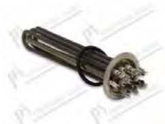
Resistenza boiler 3000W 230V L=220 mm; flangia Ø 64 mm; Øint. 50 mm; 2 x guaina portabulbo L=195 mm
